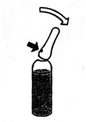
Im Ampullenspieß befindliche Lösung wie üblich nach unten fließen lassen. Der Ampullenspieß wird nach der dem farbigen Punkt gegenüberliegenden Seite hin abgebrochen.
