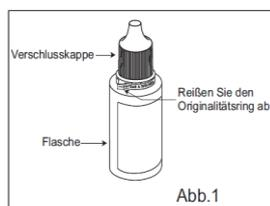
2. Bevor Sie das Tropfbehältnis zum ersten Mal öffnen, reißen Sie die Originalitätssicherung ab, um das Siegel zu brechen (Abb. 2).
